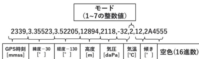
図6 LoRa による送受信データの形式 (コンマは 1 byte で、合計 47 byte)
